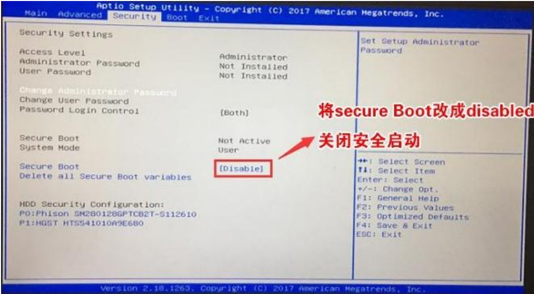
图 2.3-10 三茗机房管理系统安装完成后 BIOS 设置
